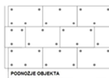
5 pričvršnica/ploča ili 8 kom/m 2 fasade
