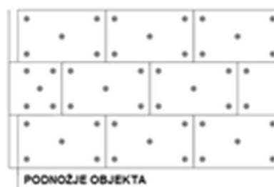
5 pričvršnica/ploča ili 8 kom/m 2 fasade
