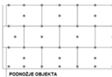
3 pričvršnice/ploči ili 5 kom/m 2 fasade
