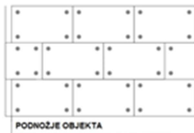
4 pričvršnice/ploča ili 6 kom/m 2 fasade
