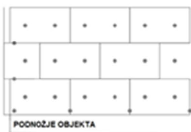
4 pričvršnice/ploča ili 6 kom/m 2 fasade
